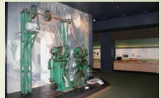
大正時代に導入された箔打機。上下運動する筒の太さが異なるものを2台備え付けます。奥に見える「おもしろ箔物館」では子どもだけでなく大人も楽しめます。
