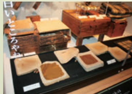
徐々に薄く打ち延ばされる金箔を、箔打紙とともに展示。打ち上がった金箔を紙から抜く「抜き仕事」と、手で行っていた箔打ちの様子も再現。
